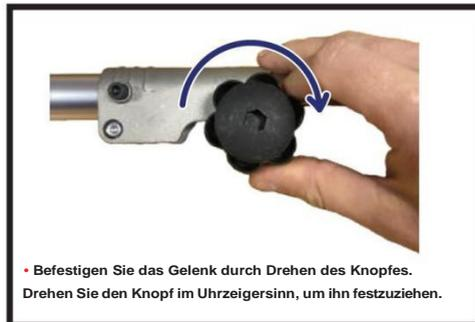
• Befestigen Sie das Gelenk durch Drehen des Knopfes. Drehen Sie den Knopf im Uhrzeigersinn, um ihn festzuziehen.
