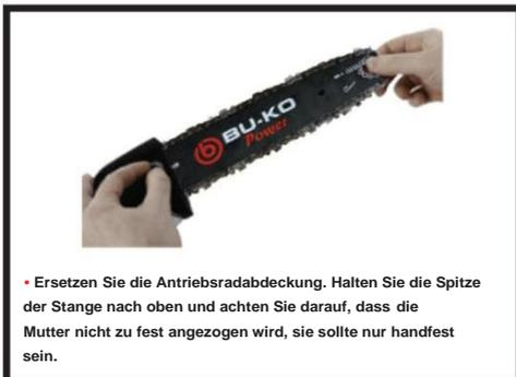
**6** EINSTELLUNG DER KETTENSpannung
