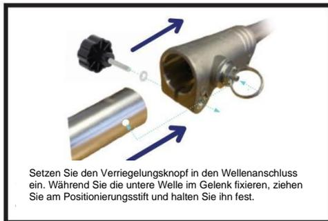
Setzen Sie den Verriegelungsknopf in den Wellenanschluss ein. Während Sie die untere Welle im Gelenk fixieren, ziehen Sie am Positionierungsstift und halten Sie ihn fest.
