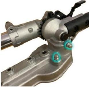
Die internen Komponenten des Heckenscherengetriebes sind während des Betriebs einer erheblichen Belastung ausgesetzt. Daher ist es unbedingt erforderlich, jederzeit für eine ordnungsgemäße Schmierung zu sorgen. Die Heckenschere wird vorgefettet geliefert. Nach 40 Betriebsstunden müssen Sie das Getriebe schmieren.
