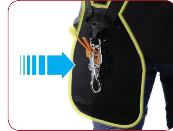
Stellen Sie sicher, dass das Oberschenkelpolster in der richtigen Position angebracht ist, damit es Sie vollständig vor Druckstellen schützt, die durch den Kontakt mit der Maschine während der Benutzung entstehen.
