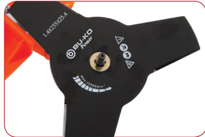
Platzieren Sie die dreizahnige Klinge so, dass das Mittelloch in der Unterlegscheibe "A" sitzt.
