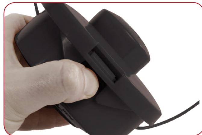
Öffnen Sie die Spule, indem Sie einen der beiden Clips drücken, um die Abdeckung zu lösen. Drücken Sie nach dem Lösen fest auf den zweiten Clip und entfernen Sie die Spulenpatrone aus dem Inneren des Gehäuses.
