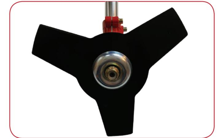
**i** **HINWEIS:** Bitte beachten Sie, dass die Unterlegscheibe 'A', die Unterlegscheibe 'B' und die 3-Zahn-Blattmutter (Sicherungsscheiben) an der Nabe der Maschine vorinstalliert sein können.
