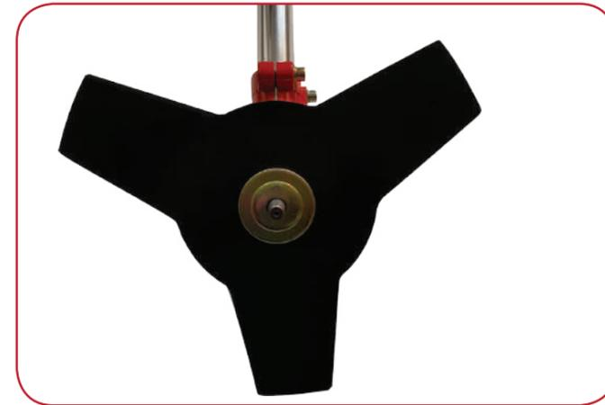
Installieren Sie die Unterlegscheibe "B" wie oben abgebildet, um das Blatt an der Welle zu sichern
