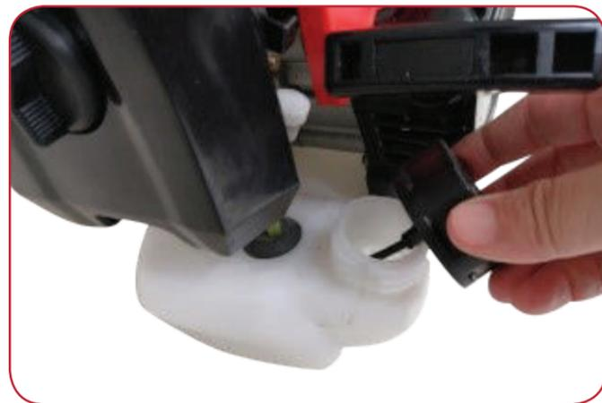
Entfernen Sie den Tankdeckel und füllen Sie den Tank zu maximal 80 % auf.
