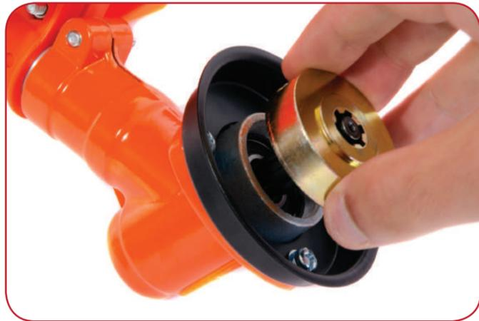
Setzen Sie die Unterlegscheibe "A" wie oben abgebildet ein. Richten Sie die Bohrung in der Unterlegscheibe auf die Bohrung im Spulenbund aus.
