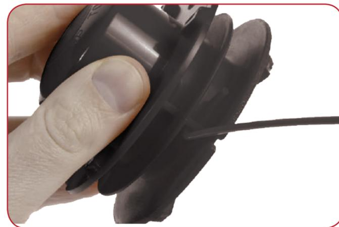
Die Patrone besteht aus zwei Wicklungen, die in der auf dem Gehäuse angegebenen Richtung gewickelt werden müssen. Befestigen Sie den Ersatzdraht wie abgebildet an der Patrone.
