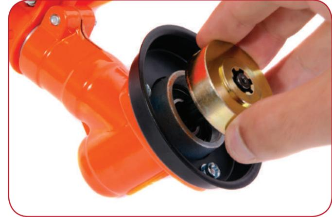
Installieren Sie die Unterlegscheibe "A" wie oben abgebildet. Richten Sie die Unterlegscheibe auf die Bohrung am Spulenbund aus.
