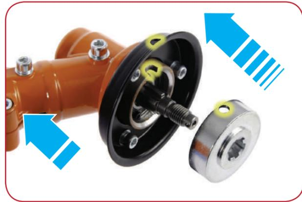
Richten Sie die Löcher am Bund, der Unterlegscheibe "A" und der Achse aus. Die oben hervorgehobenen Bereiche.
