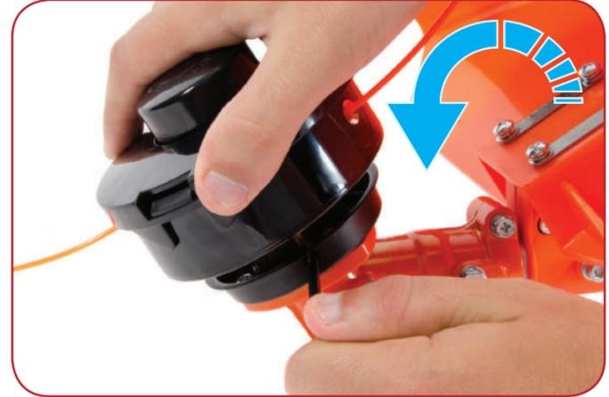
Arretieren Sie die Achse, indem Sie den Fremdschlüssel in die Aufnahmebohrung des Bunds stecken und die Spule durch Drehen gegen den Uhrzeigersinn auf das Gewinde aufspulen.
