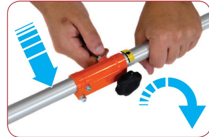
Lassen Sie den Stift los und drehen Sie die Unterwelle, bis das Gelenk eingerastet ist.
